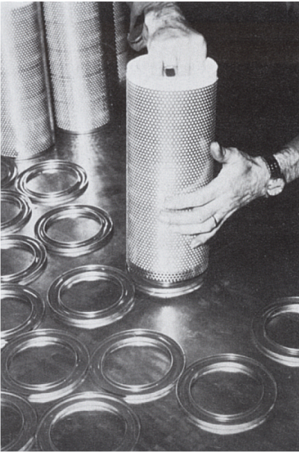
figuur 2.96 Vervaardiging van filterelementen (foto CIBA)
