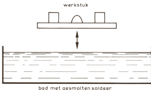
figuur 2.14 Principe van het dompelsolderen
