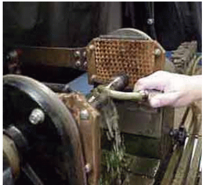
figuur 4.7 Magneetbank, waarbij een as wordt ingeklemd en tijdens de stroomdoorvoer wordt voorzien van magnetische testinkt ( http://www.ndt-ed.org )
