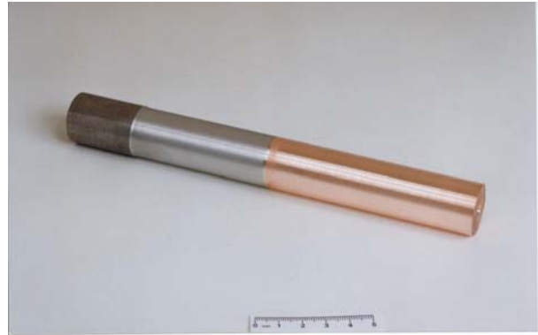
figuur 13.4 Verbinding van koper aan staal vervaardigd door middel van het wrijvingslassen
