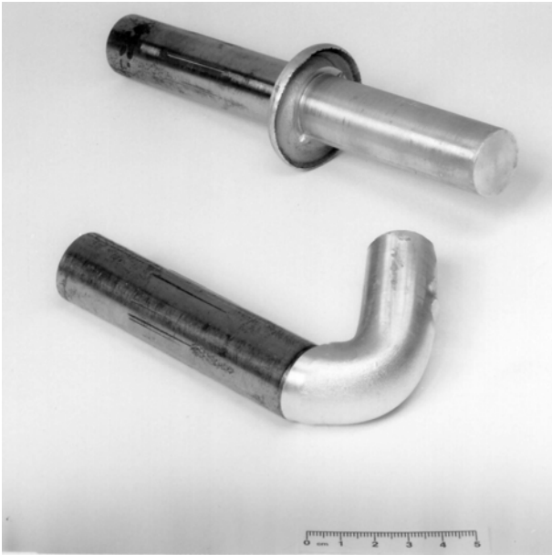
figuur 12.3 Verbinding van aluminium aan staal vervaardigd door middel van het wrijvingslassen
