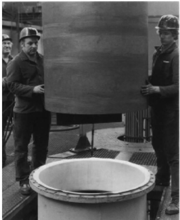
figuur 4.5 Opsluiten van de PTFE liner door middel van een grafieten binnenwand
